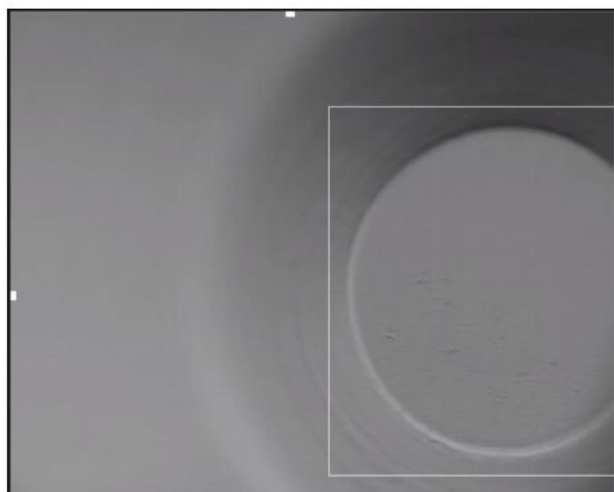
Figura 20.38 Ejemplo de un pocillo colocado incorrectamente en la pantalla de la vista de cámara
