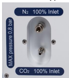
Figura 11.1 Entradas de gases
