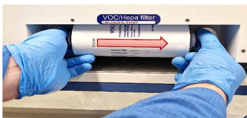
Figura 12.2 Procedimiento de inserción y extracción del filtro COV/HEPA
