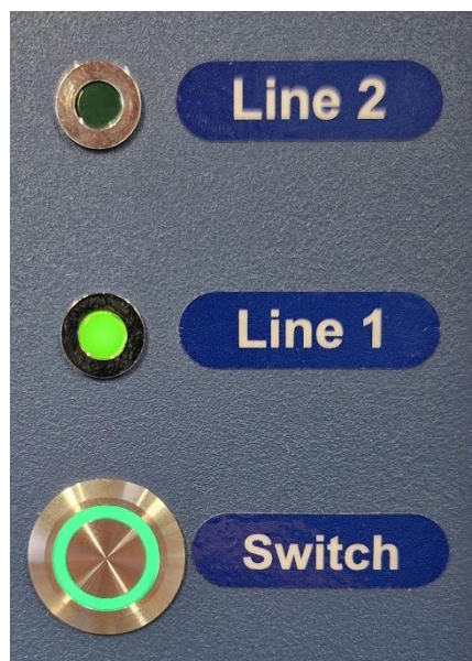
Figura 20.2 El interruptor que cambia la línea de la incubadora multicámara FIV MIRI® TL12 y la Línea 1 activa
