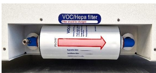
Figura 12.3 Filtro COV/HEPA correctamente instalado
