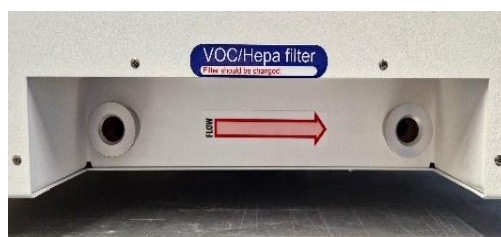
Figura 12.1 La flecha de flujo en las incubadoras multicámara FIV MIRI® TL6 y MIRI® TL12
