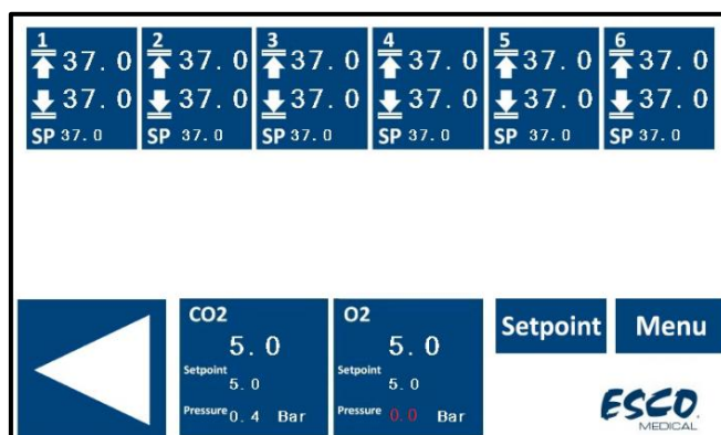
Figura 14.8 Vista de la alarma de presión de gas N 2 en la pantalla principal de la incubadora multicámara FIV MIRI® TL6
